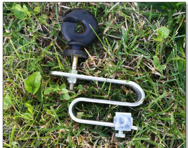
**Fig. 7 y 8: Colocación de las espigas-aisladas en los armados para construir los circuitos de protección del pastor eléctrico.** Los operarios de EDS, especialistas en instalaciones eléctricas de alta tensión, colocan cuidadosamente las espigas para crear los circuitos que protegerán todo el armado, sin dejar ningún punto accesible de posada en las crucetas.
